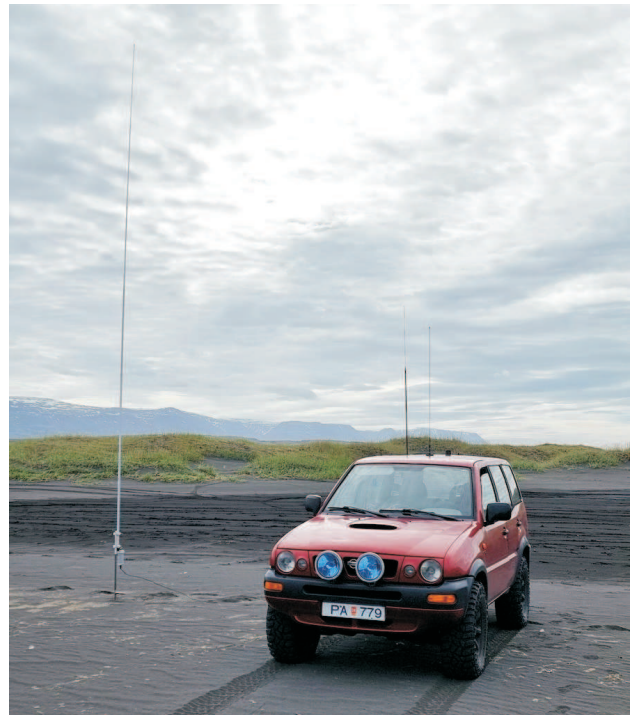
6,4 metra hátt Diamond BB-7V stangarlofnet TF4WD uppsett í fjörunni í námunda við Sauðarkrök. Ljósmynd: TF4WD.
