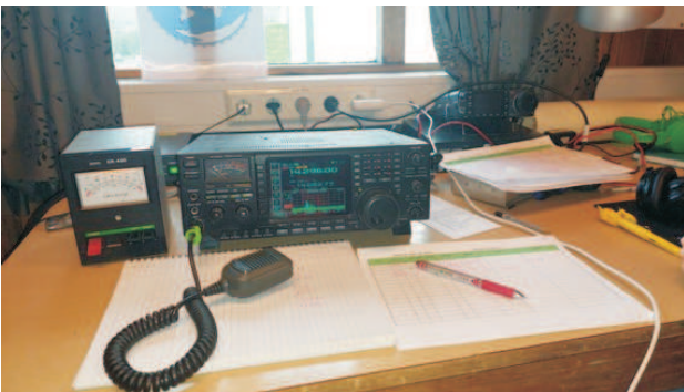
Fjarskiptaaðstaða TF1SS á Úlfjótavatni. Icom IC-756 PRO II og IC-7000. Loftmet: 3 staka Fritzel Yagi loftnet fyrir 20, 15 og 10 metra. Ljósmynd: TF8RN.
