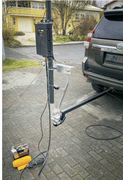
Vertical“ fyrir HF böndin, settur á framlengingu aftan úr bílnum. Sjá má 12V 7Ah rafhlöðuna fyrir „tjúnerinn“ sem er á stönginni. Slík rafhláða dugði allan tímann án hleðslu.
