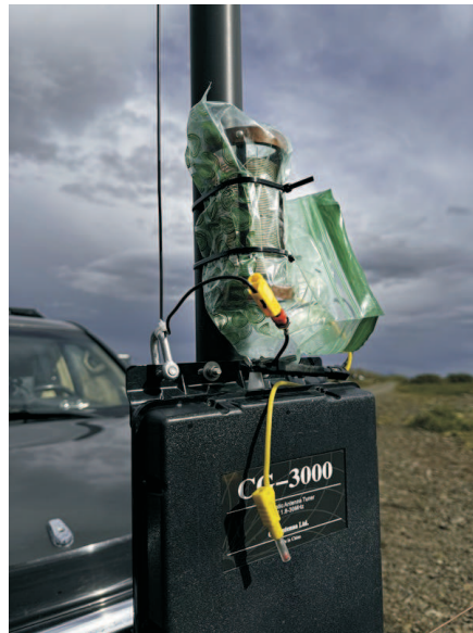
Spóla var spennt á stöngina fyrir ofan „autótjúnerinn“. Plastpokinn er til varnar rigningu.
