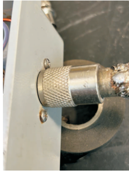
Mynd 5. Róin á karltenginu leggst alveg að veggnum.
