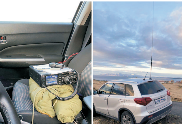
TF3E notaði Diamond RHM-12 loftnet á segulfæti í Páskaleikunum. Það er fyrir öll bönd frá 160-70 cm en vel fór um Yaesu FT-991A HF/VHF/UHF stöðina í bílum hjá honum. Ljós.: TF3E.
