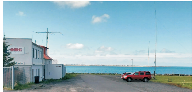
Skeljanesi 26. maí. Hægra megin á myndinni má sjá hluta af 80 metra færanlegu stangarloftneti sem TF3SG lánaði til notkunar í keppninni. Fjær (nær sjónum) má sjá 18 m glertrefjastöngina frá Spiderbeam sem TF3CW lánaði til notkunar í keppninni og heldur uppi delta neti á 40 m.
