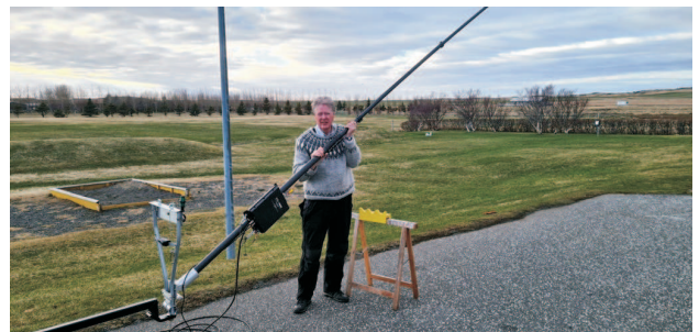
TF1AM reisir 8 m. háa rápstöngina á festinguna á bílum. Loftnetsaðlögunarrásin er CG-3000 frá CG Antenna.
