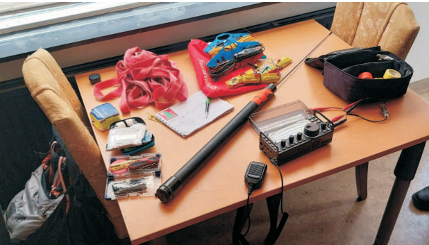
Mynd af búnaðnum sem Ralf notar. Nokkrar tegundir loftneta og Elecraft KX3 HF stöðin sem hefur 15W sendiafl.
